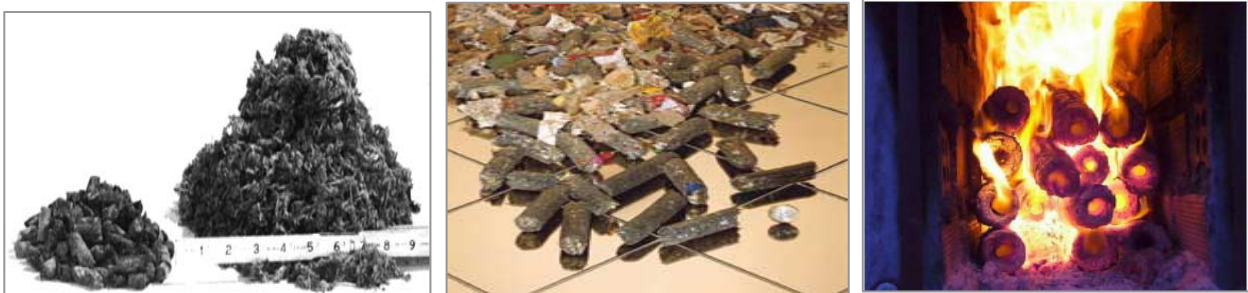
ภาพที่ 3 การนำขยะที่เผาได้ไปบดและอัดเป็นแท่งเชื้อเพลิง RDF ก่อนนำไปใช้เป็นเชื้อเพลิงในการเผาไหม้
